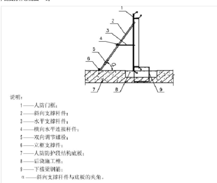
图8 人防门框孔净宽 B≤1500mm 时的支撑体系示意图
