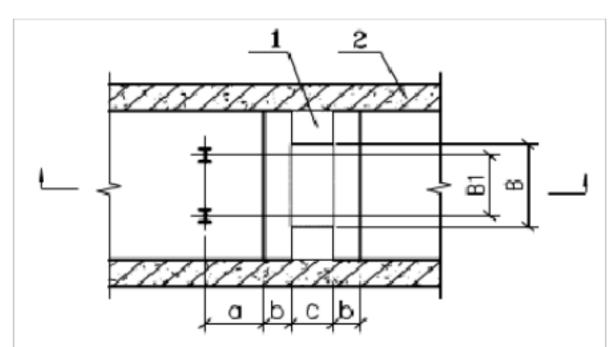
a) 结构底板预埋立框支撑件及预留后浇施工槽平面示意图
