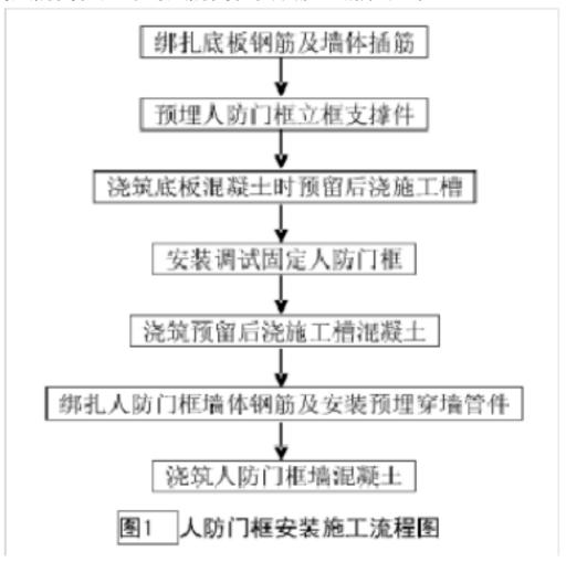
**6.1.1.2** 地铁区间人防门框安装流程应由人防专业设计根据其构造给出, 施]门安装队应依据设计给出的流程进行施工。
