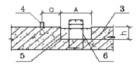
b) 结构底板预埋立框支撑件及预留后浇施工槽剖面示意图
